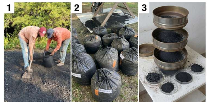
Figura 1: Secuencia de recolección de la carbonilla, 1) en la playa del horno del carbón, 2) muestras de 10 kg y 3) muestras diferenciadas por tamaño de grano.
